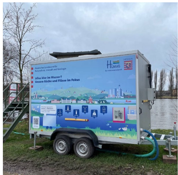
Abb. 42: Mobile Messstation zur flexiblen kontinuierlichen Gewässerüberwachung, bei Schadensfällen oder Belastungen unklarer Herkunft und zur Dokumentation bereits durchgeführter Maßnahmen © HLNUG
