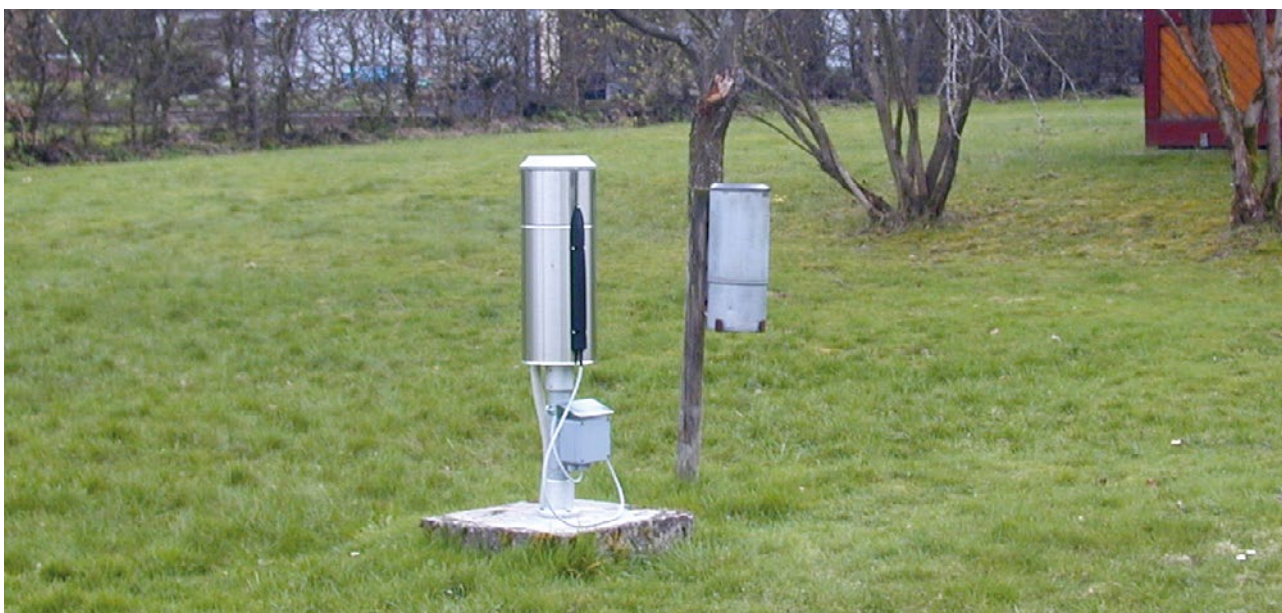
Abb. 7: Niederschlagsmessstelle Grebenhain-Ilbeshausen-Hochwaldhausen (links: Pluviometer, rechts: Hellmann-Messgerät) © HLNUG
