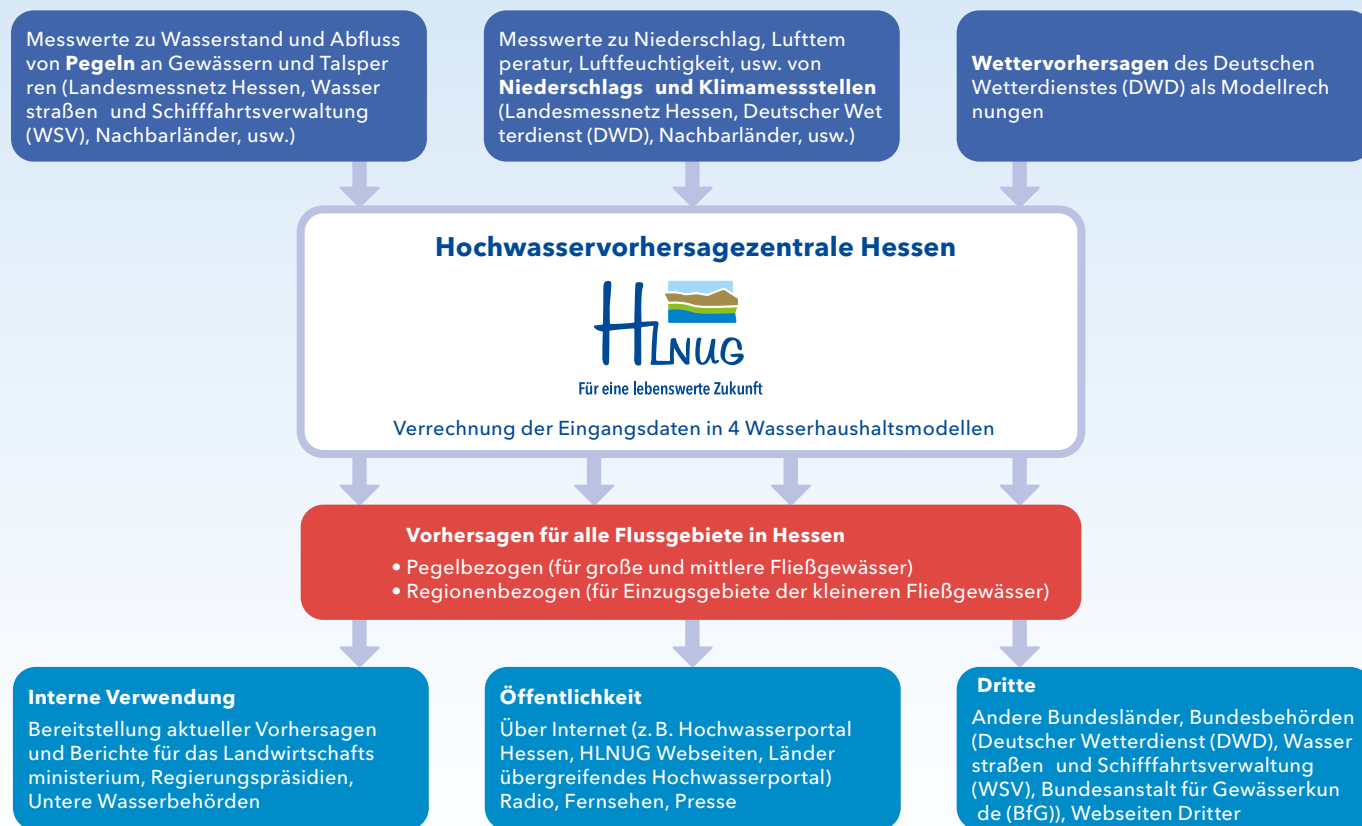
Abb. 5: Schema der Datenflüsse der Hochwasservorhersagezentrale Hessen
