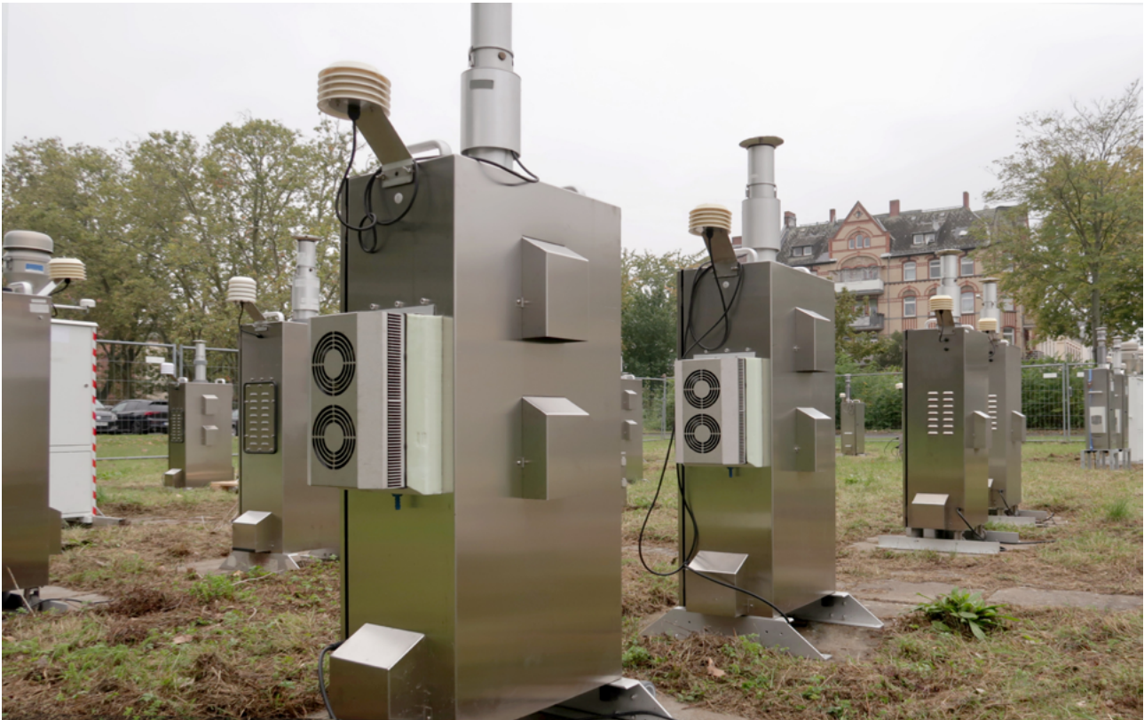
Abb. 18: Mess- bzw. Versuchsfeld des HLNUG in Wiesbaden. Zu sehen sind unterschiedliche High- und Low-Volume-Sampler der teilnehmenden Messnetze © HLNUG
