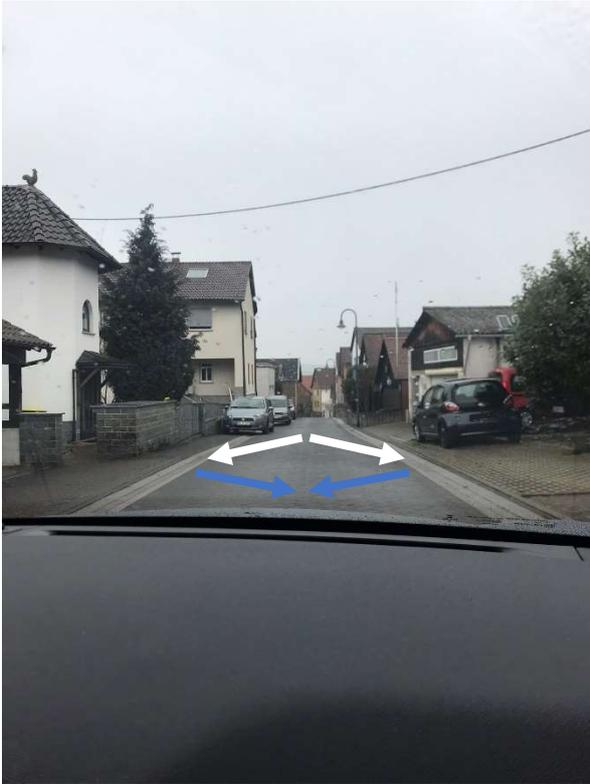
Abbildung 50: Aktueller Wasserabfluss in der Obergasse (weiß) vs. Abfluss mit Mittelrinne (blau) (eigene Aufnahme)
