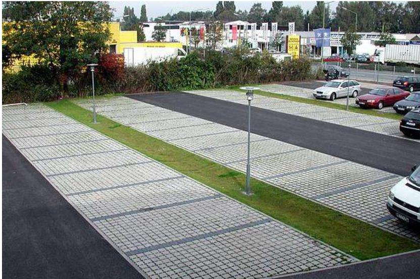
Abbildung 47: Durchlässige Pflasterbeläge ([Durchlässige Pflasterbeläge | Sieker](#))
