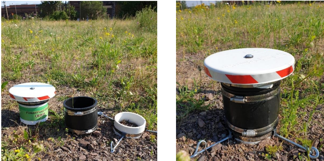
Abb. 2: Vor Ort installierte Fossil-Fuel Trap. Bild links: Einzelkomponenten bestehend aus Sammler mit Sorptionsmedium und Regenschutz (links), Zwischenelement (mittig) sowie im Boden eingebrachtes Außengehäuse (rechts). Bild rechts: zusammengesetzte Fossil-Fuel Trap
