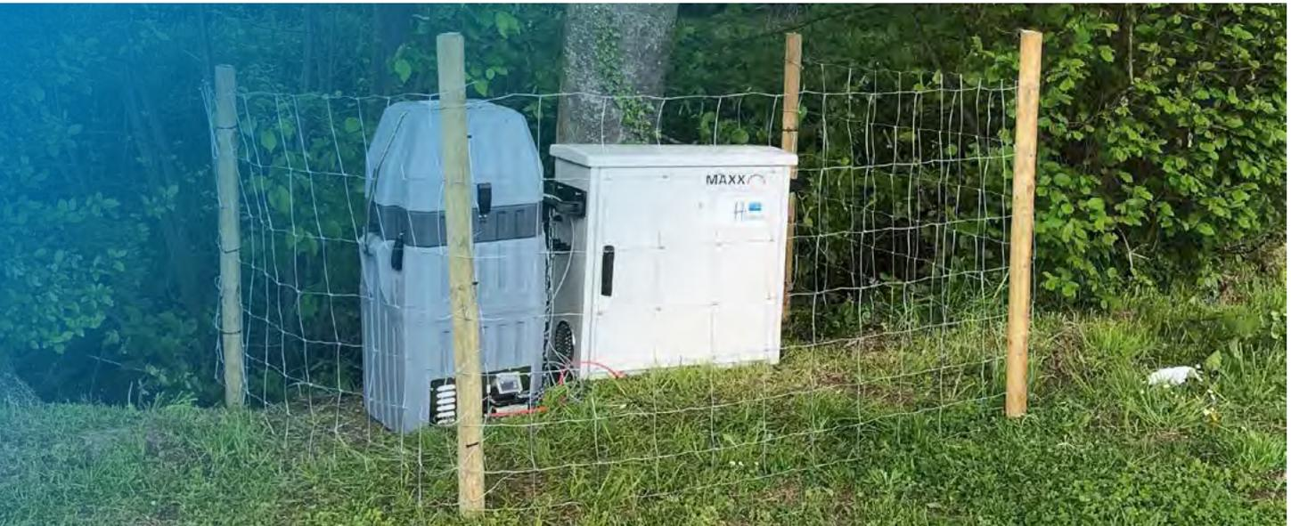
Abb. 4: Foto des Aufbaus eines automatischen Probennehmers am Gewässer zur Beprobung von Regenereignissen
