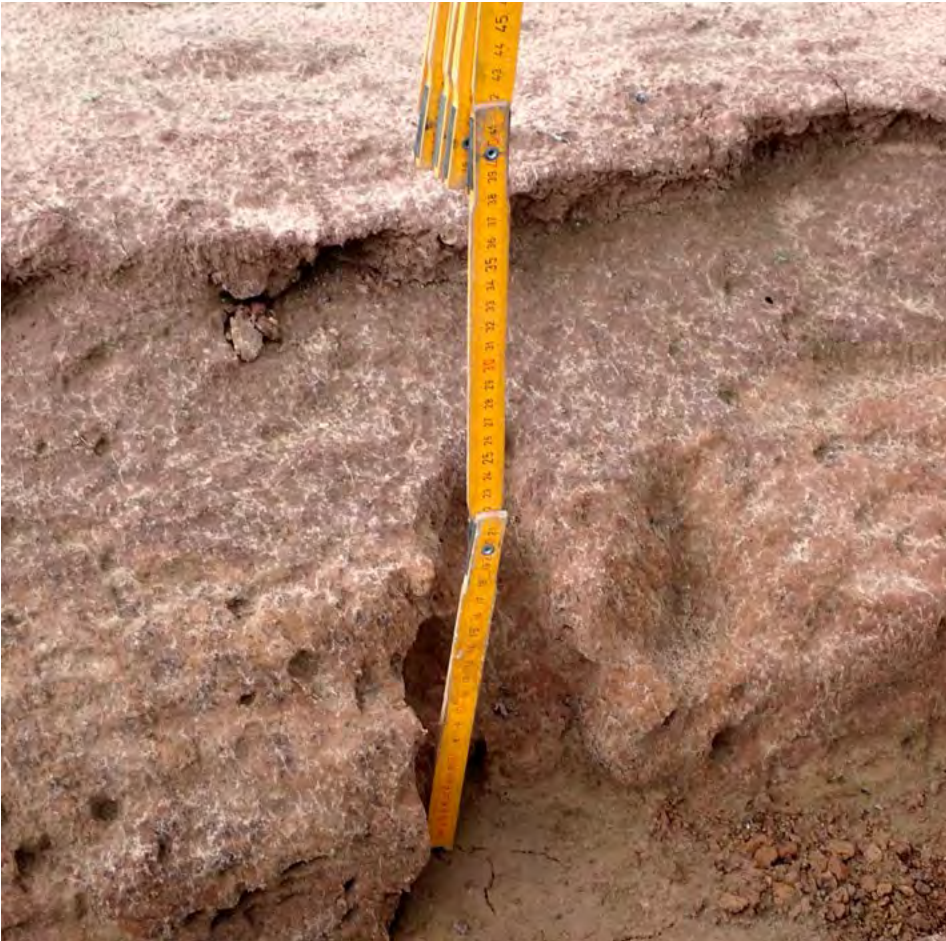
Abb. 4: Aufnahme der Tiefe einer Erosionsrinne © HLNUG
